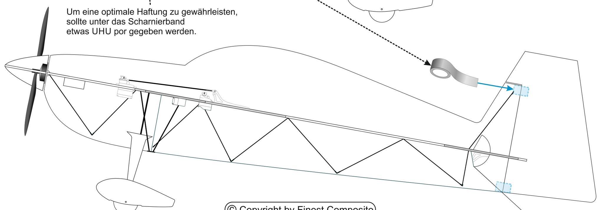
Um eine optimale Haftung zu gewährleisten, sollte unter das Scharnierband etwas UHU por gegeben werden.
